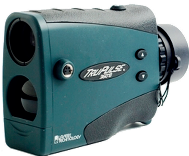
Obrázek 4 • Ukázka lesnického dálkoměru s funkcí vzdáleného měření průměru a ukázky měření (zdroj www.fieldmap.cz ).
