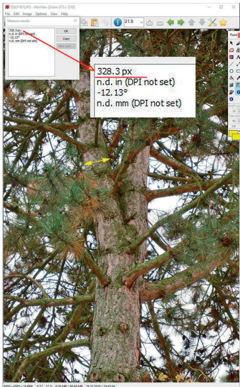
Obrázek 6 • Následný výpočet průměru větve (foto S. Burian).
